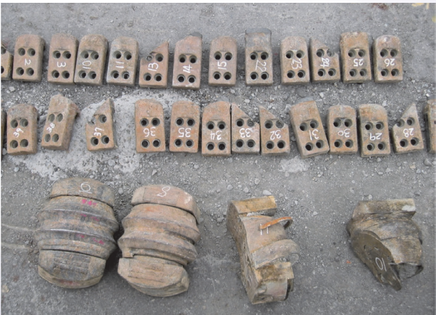
（來源：台灣世曦） 圖 6 放流管第四標刀具磨損更換照片（2/2）
