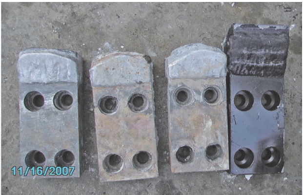
（來源：台灣世曦） 圖 5 放流管第四標刀具磨損更換照片（1/2）
