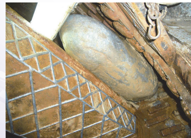
圖 1 機頭破碎艙遭礫石卡住現況
