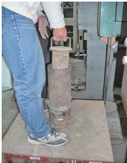
圖 16 相對密度試驗（ASTM D4253） 照片來源：成功大學土木系，倪勝火，土壤力學實驗手冊
