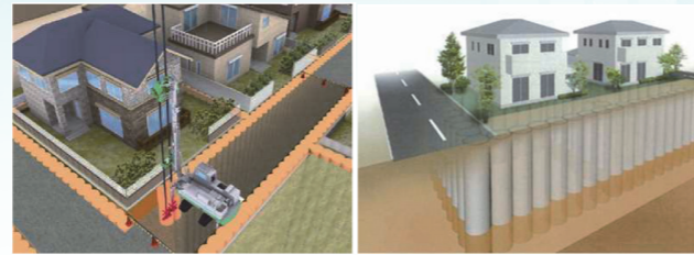
圖 10 公共設施和宅地一體型對策 - 格子狀地中壁工法示意（日本國土交通省，2019）
