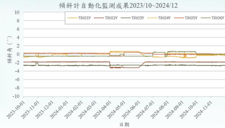
圖 26 傾度盤 y 向監測成果(112/10 ~ 113/12)
