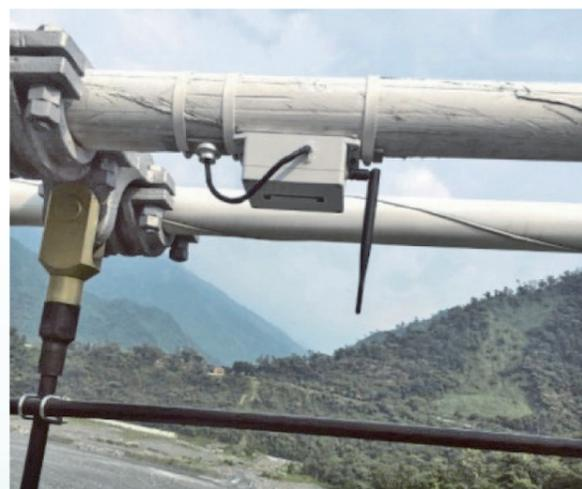
圖 19 加速規之現場安裝與監測照片
