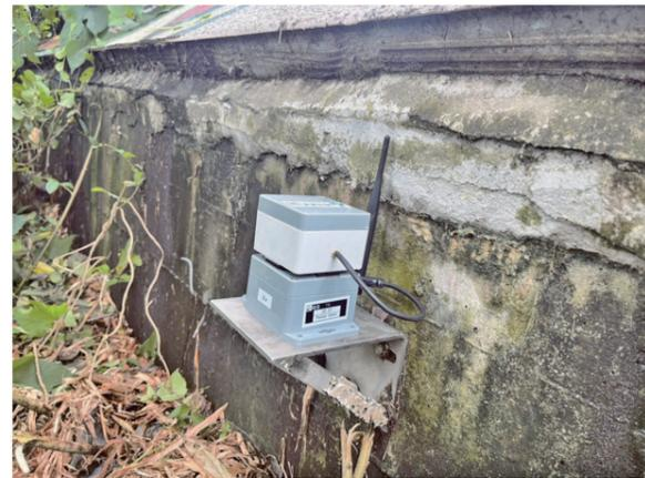
圖 24 無線傾度盤裝置照片
