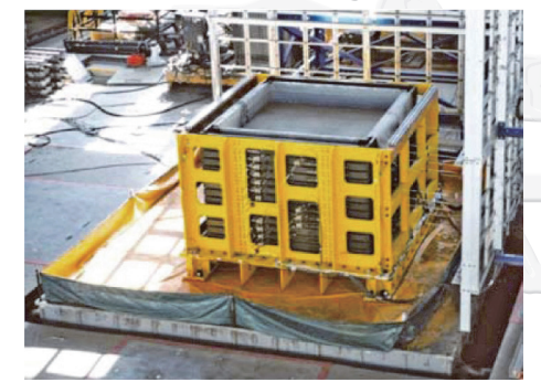
(a) 國震中心大型二維剪力試驗箱與振動臺（國震中心陳家漢博士提供）
