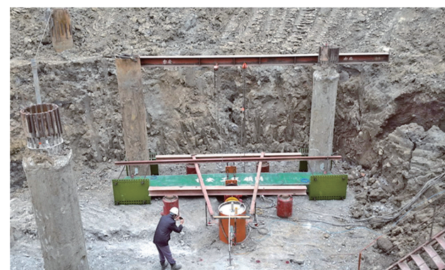
圖 21 側向反覆 (500 次) 加載試驗 (2015, 台安技術提供)
