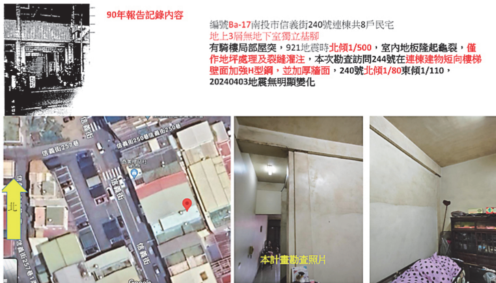
圖 7.2-11 南投信義街民宅在短向樓梯壁面加強 H 型鋼並加厚牆面
